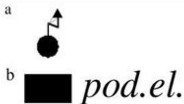
Transformator, podstacja elektryczna
